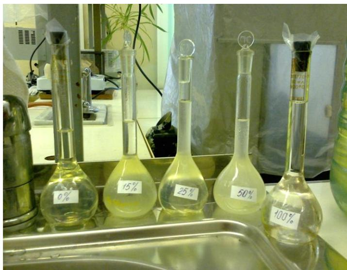
Рис. 1. Общий вид проб этанола-топливных эмульсий
