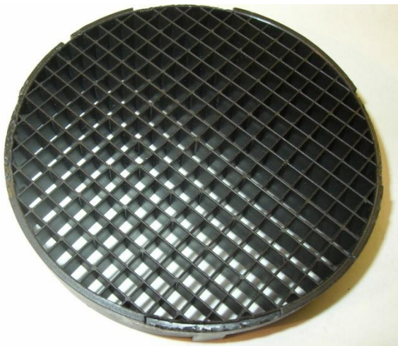
Рис. 4. Стандартный стабилизатор потока ДМРВ
