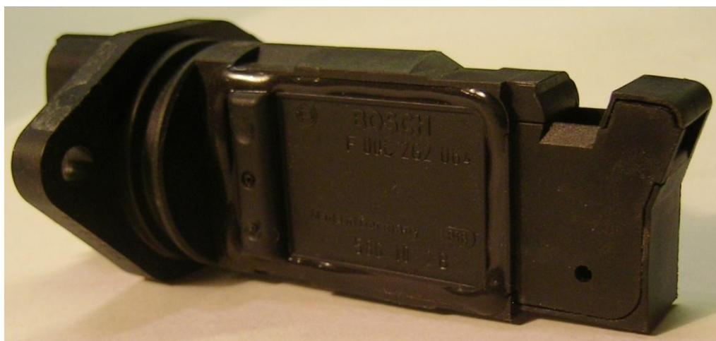
Рис. 3. Применённый ДМРВ (съёмный чувствительный элемент)
