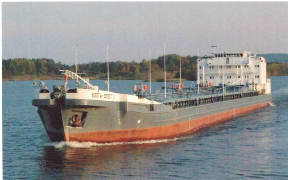
Рис. 5. Речной танкер г/п 5000 т созданный из ведущей секции составного сухогруза типа «Волжский»
