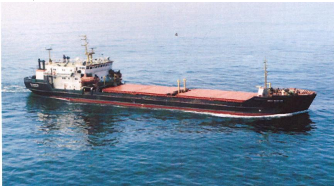
Рис. 9. Сухогрузный теплоход проекта 16510 смешанного плавания дедвейтом 4500т
