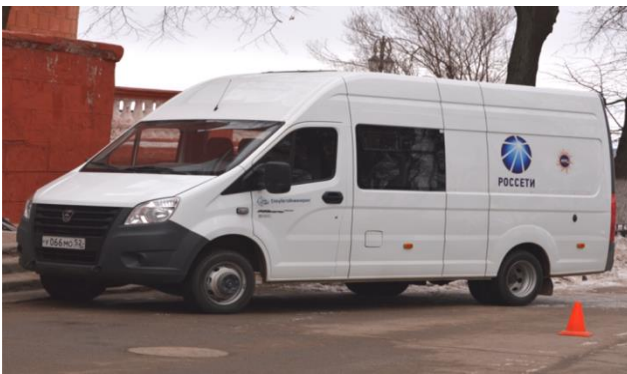
Рис. 2. Электромобиль ГАЗель NEXT Electro (разработка ООО «ОИЦ» и лаборатории СпецАвтоИнжиниринг)
