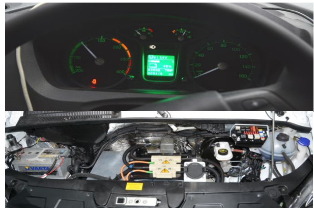
Рис. 2. Электромобиль ГАЗель NEXT Electro (разработка ООО «ОИЦ» и лаборатории СпецАвтоИнжиниринг)
